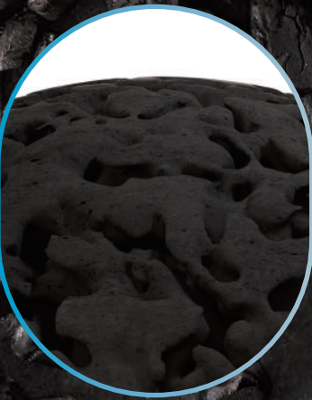
活性碳表面充滿孔隙，孔隙越多， 代表吸附力越強
